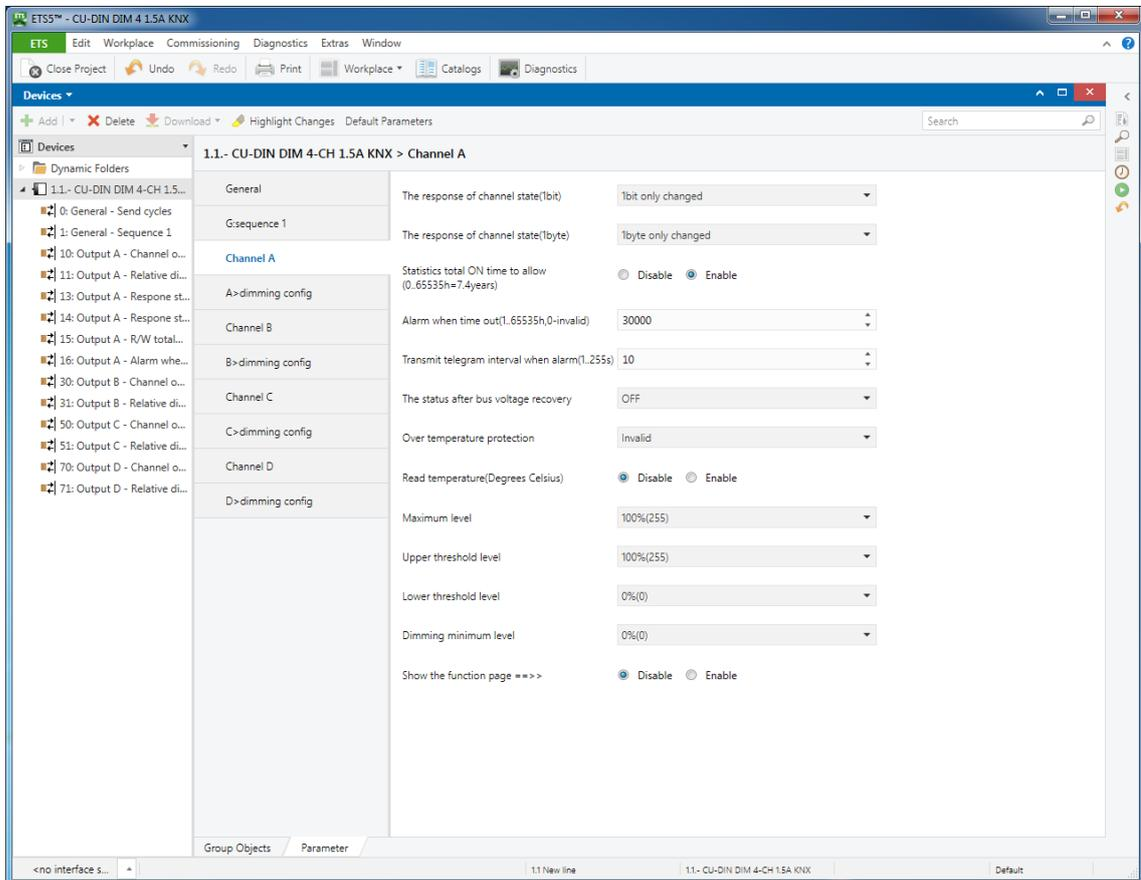
**Fig. 2:** “Channel N” parameter (N=A,B,C...) windows
